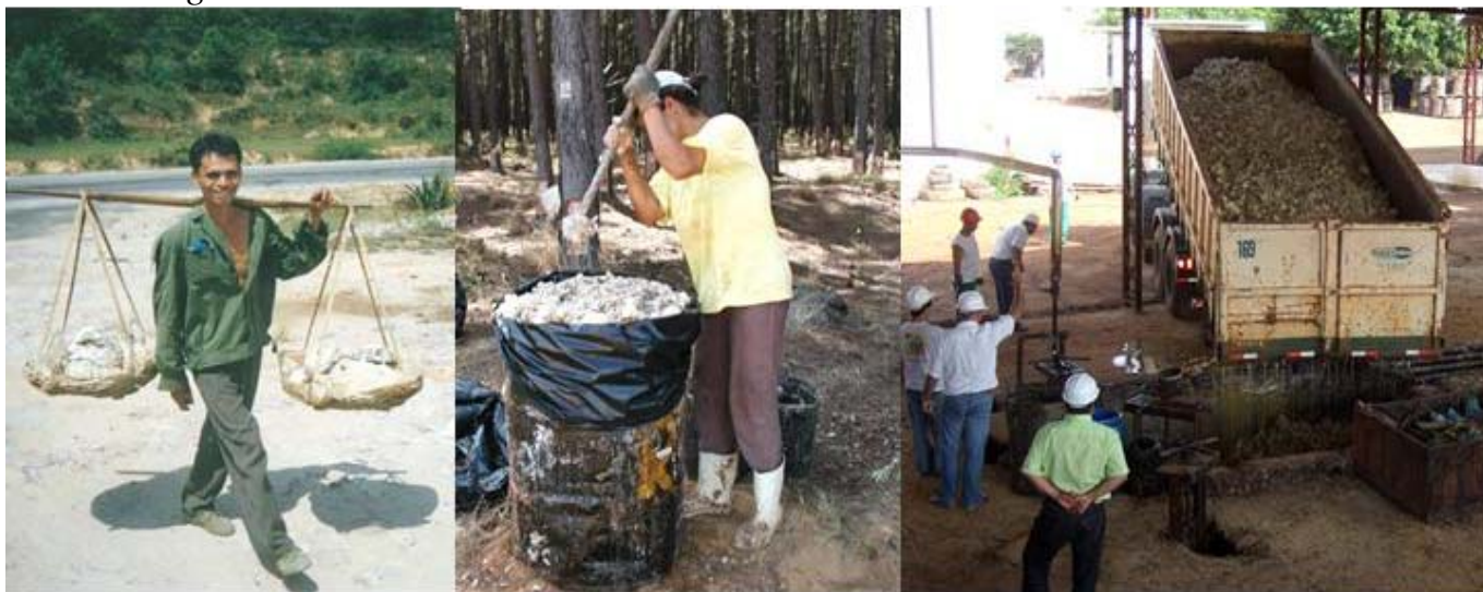
Figura 1: (1a) Entrega de miera a pié de P. massoniana en China – 1998; (1b) Acondicionamiento de la miera de P. caribaea en Brasil en tambores de 200kg recubiertos por un saco plástico interno – 2008; (1c) Descarga de un camión con miera de P. caribaea a granel en Brasil – 2009.
